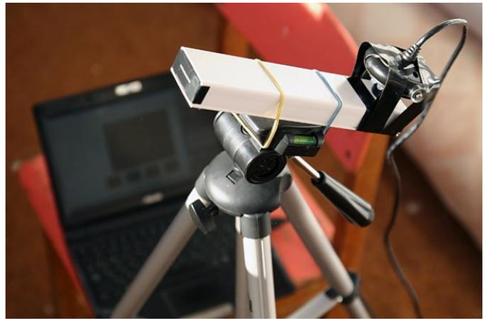
Для проверки изготовленного устройства направьте его на любую энергосберегающую лампу - они имеют спектр, состоящий из нескольких ярких линий разных цветов. Спектр лампы накаливания, напротив, выглядит непрерывной радугой. Но наиболее интересный и доступный объект - Солнце. В его спектре легко можно увидеть основные линии поглощения (франгоуферовы линии).
