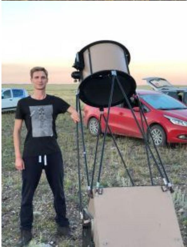
Для наблюдения таких объектов важен диаметр главного (собирающего свет) зеркала – ведь чем оно больше, тем ярче и лучше проявится изображение при взгляде в телескоп.
