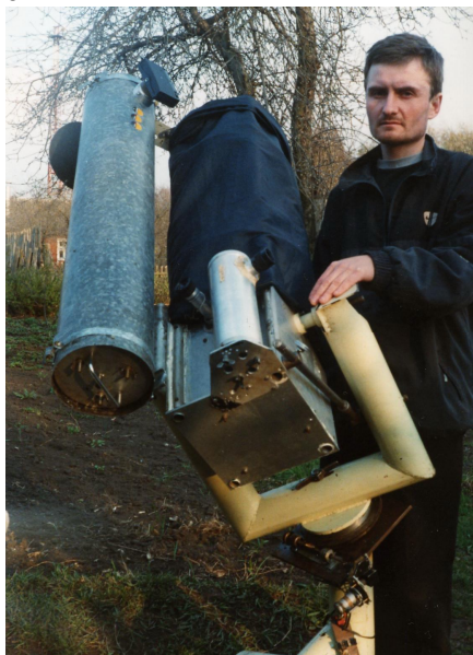
Телескоп системы Кассегрена, диаметром 200 мм с часовым электроприводом, построенный в 1995г. для фотографирования «Города» на Луне. Автор Кулешов Н.В.
